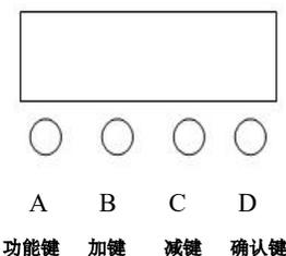
操作说明: 按功能键 A 会循环出十种不同的功能效果, 数码管前两位数字代表当前所处的功能 (参照功能表)。后两位数字代表该种功能所处的地址码或速度、的参数。按 B 或 C 键即可修改其参数值。按 D 键确认即可。
