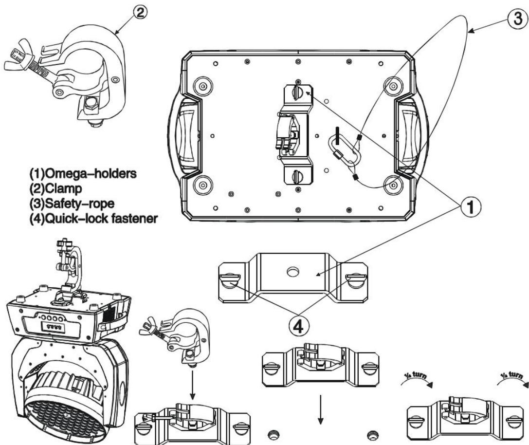
不管您选择哪种吊挂，请谨记务必使用安全绳。产品底部有配备专门的安全绳吊挂点，请参考上图，而且请谨记使用专门提供的安全
