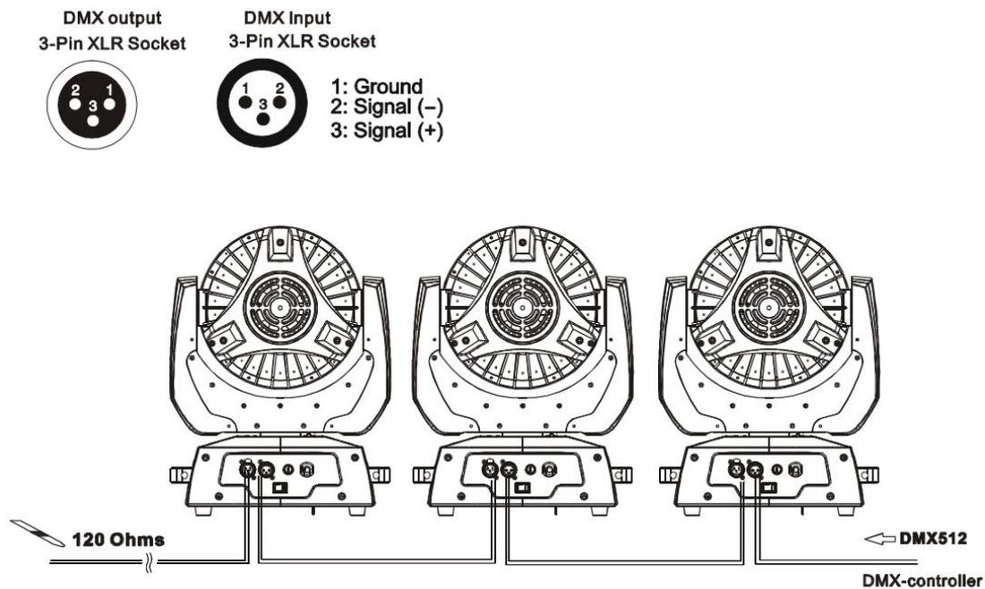
DMX-512 连接需带终端器（回路连接）
